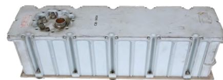
Figure 2. Amplificateur en bande S Collins Radio à tube à ondes progressives utilisé pour la communication avec la Terre pendant la mission Apollo. (Source : Ken Shirriff)
