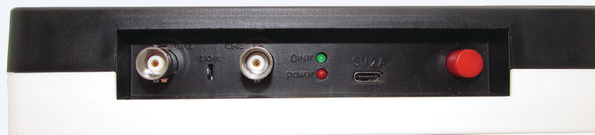
Figure 2. Interrupteur d'alimentation, connecteurs et témoins.
