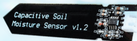
Figure 3. Exemple de capteur capacitif basse fréquence. (source : [3]).
