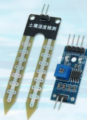
Figure 2. Capteur pour la mesure de la conductivité (YL69 ou similaire) ; source : [2].
