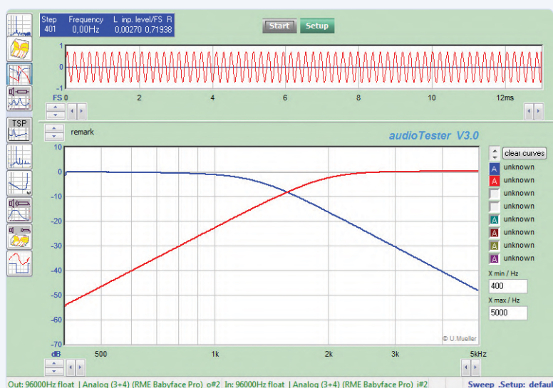
Figure 15. Réponses d'un filtre passe-bas 1,2 kHz et d'un filtre passe-haut 2 kHz (filtres de Butterworth), échelle log. de fréquence.
