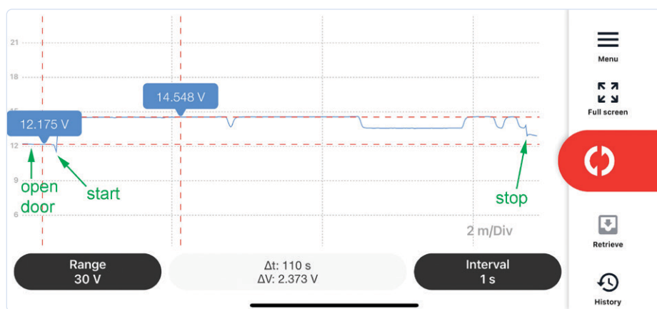
Figure 13. Tracé de l'enregistreur de données. Sept minutes de la vie de la batterie de ma voiture, échantillonnées seconde par seconde.
