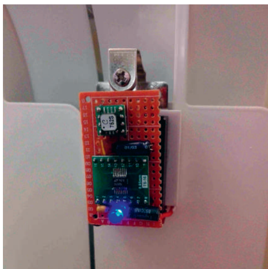
Figure 2. Circuit installé sur la face avant d'un radiateur, fonctionnant lorsque sa température commence à augmenter.
