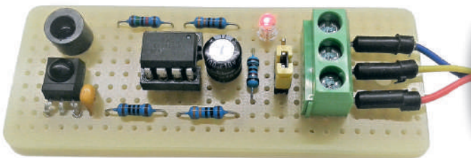
Figure 3. Il peut être nécessaire de protéger la LED IR avec un court morceau de tube en plastique pour éviter toute instabilité de fonctionnement due à un faisceau lumineux IR trop large.
