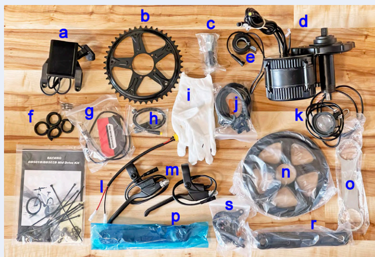
Figure 3. Contenu de la livraison sans la batterie : (a) écran avec support, (b) plateau, (c) extracteur de bras de manivelle, (d) moteur, (e) accélérateur au pouce, (f) bague d'espacement gauche, (g) adaptateur USB/TTL, (h) capteur de changement de vitesse, (i) gants, (j) faisceau de câbles, (k) lampe frontale à LED, (l) connecteur de batterie, (m) leviers de frein, (n) protège-plateau, (o) clé de roulement de pédalier, (p) bras de manivelle gauche, (r) bras de manivelle droite et (s) support de moteur.
