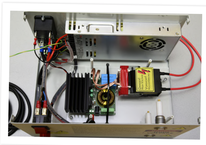
Figure 1. Générateur Lichtenberg (Photo : Ilse Joostens).
