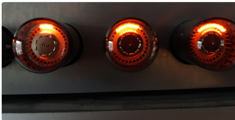
Figure 7. Zoom sur trois afficheurs dekatron.
