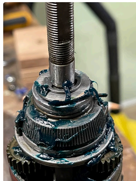
Figure 6. Le mécanisme interne d'un moyeu à sept vitesses, re-graissé après avoir retiré le frein à rétropédalage.
