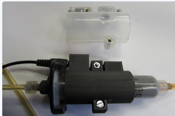
La version noire imprimée en 3D qui s'adapte à la seringue de 30 cc en noir
