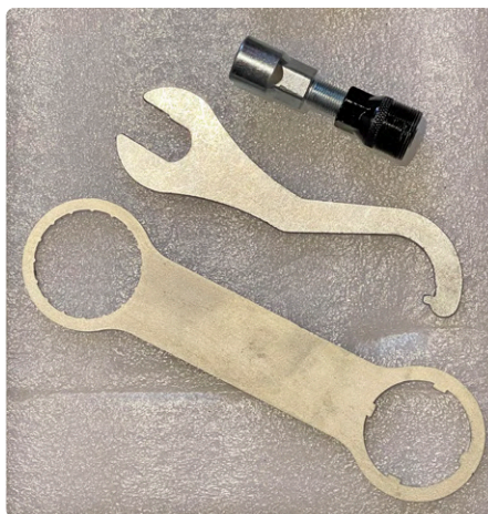
Figure 5. L'extracteur de manivelle en haut et la clé en bas faisaient partie de la livraison. J'ai dû commander séparément la clé à ergot au milieu.
