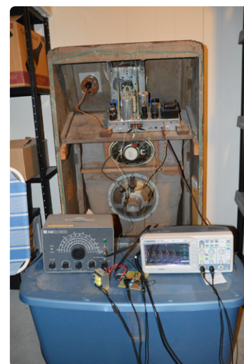
Figure 10. L'amplificateur à faible facteur Q utilisé pour mesurer la fréquence d'une antenne cadre sur une vieille radio.
