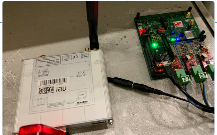
Figure 5. Mesure du courant avec un capteur à effet Hall. (Source : Würth Elektronik eiSos)
