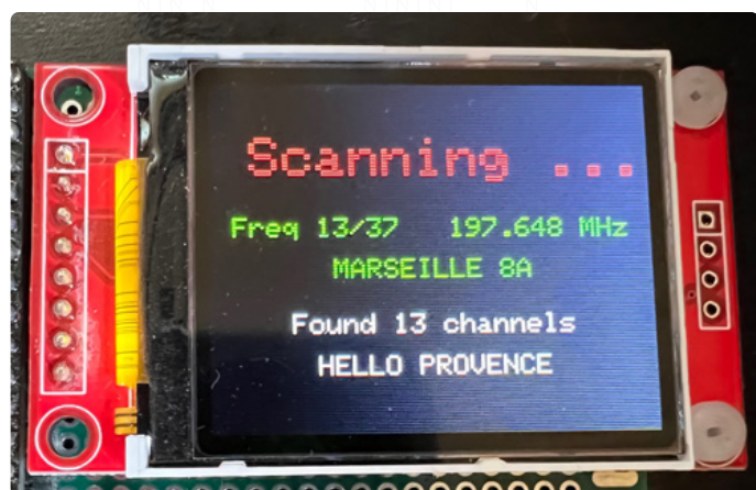
Figure 6. Ici nous voyons que le multiplex MARSEILLE 8A est trouvé et qu'il contient 13 stations. HELLO PROVENCE est la première.
