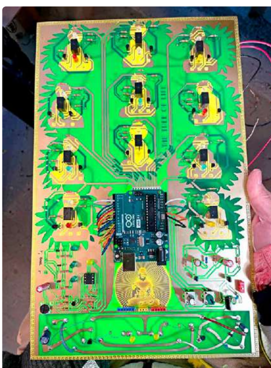
Figure 4 . À gauche, le fichier de conception du dispositif The Tree of Life dans le Circuit Garden, 2022. À droite, le circuit imprimé avec un Arduino UNO intégré. (Source : Kelly Heaton)
