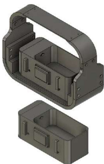
Figure 12. Réalisation complète du boîtier et du réservoir d'eau.
