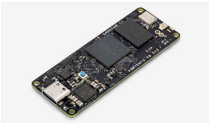
Figure 1. Portenta X8 est un module puissant, de qualité industrielle, avec un système d'exploitation Linux préchargé, capable d'exécuter des logiciels indépendants du périphérique grâce à son architecture de conteneur modulaire.
