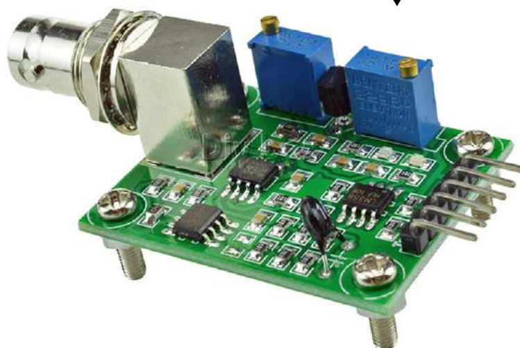
Figure 10. Le « pH Sensor v1.1 » est compliqué à étalonner. (Source : [10])
