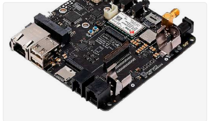
Figure 2. Le Max Carrier transforme les modules Portenta en ordinateurs monocartes ou en conceptions de référence qui permettent une IA périphérique pour les applications industrielles, d'automatisation des bâtiments et de robotique à haute performance.
