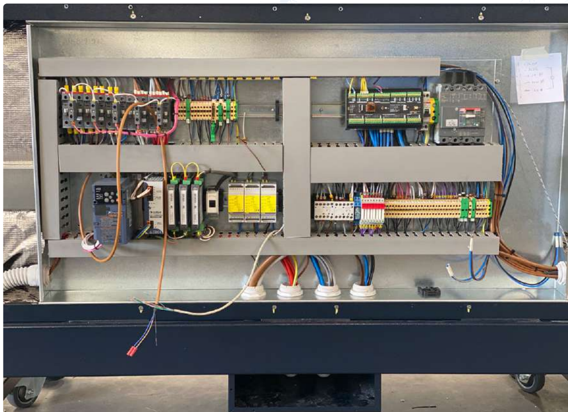
Figure 2. Four intelligent réalisé par Rinaldi Superforni à l'aide de l'Arduino Portenta Machine Control. (Source : Rinaldi Superforni)
