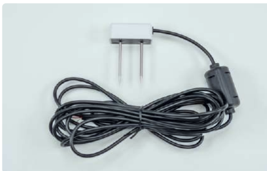
Figure 3. Capteur TEROs 10. (Source : Kristoffer Engdahl / Arduino)
