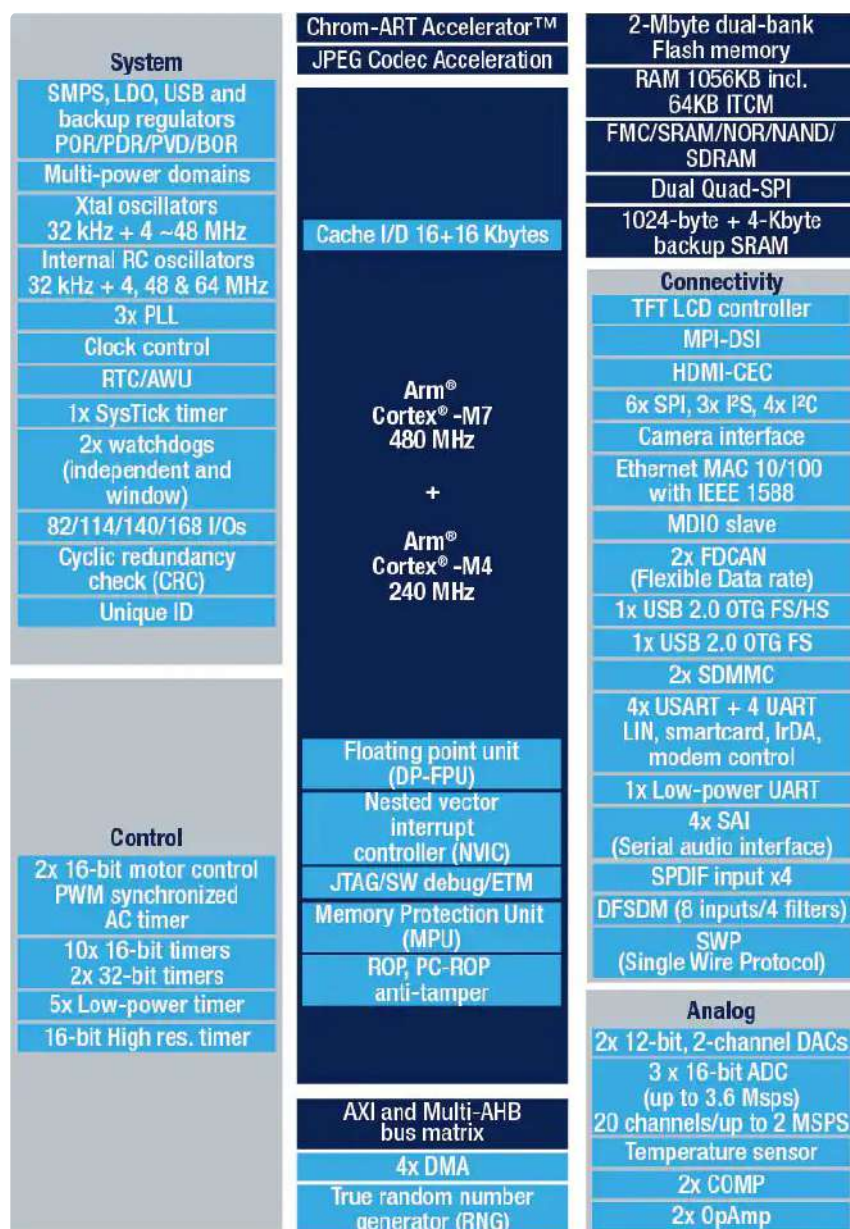
Figure 8. Vue d'ensemble du STM32H747XI (Source : STMicro, https://bit.ly/3xoRTDF )
