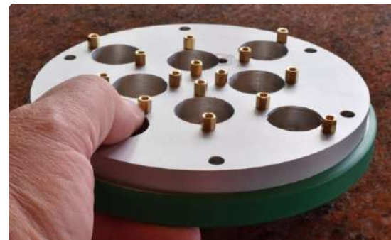
Figure 10. Les entretoises s'accordent très bien à la plaque d'aluminium massif.
