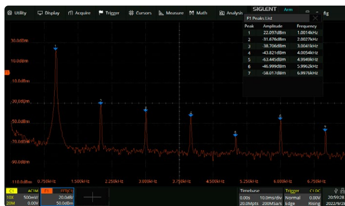
Figure 4. Spectre FFT du signal de sortie.
