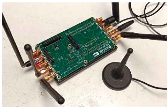
Figure 1. L'Opera Cake de Great Scott Gadgets est un commutateur d'antenne pour HackRF One.
