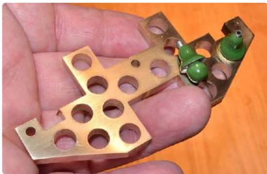
Figure 11. Conçu spécifiquement pour les tubes : un « circuit imprimé » en laiton massif.
