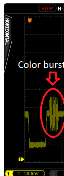
Figure 14. Oscilloscopie de la salve de couleurs d'un signal PAL.
