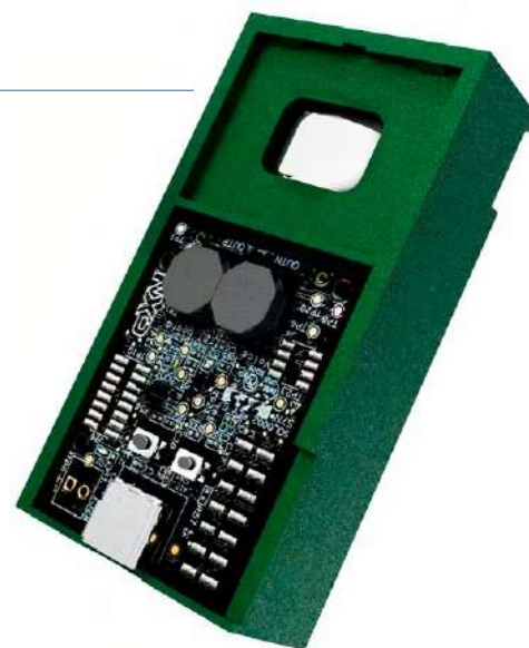
Figure 3. Solution de commande vocale hors ligne SLN-LOCAL2-IOT par NXP. (Source : NXP [10])
