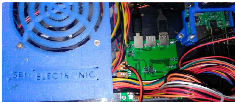
Figure 4. Alimentation ATX connectée au PCB.
