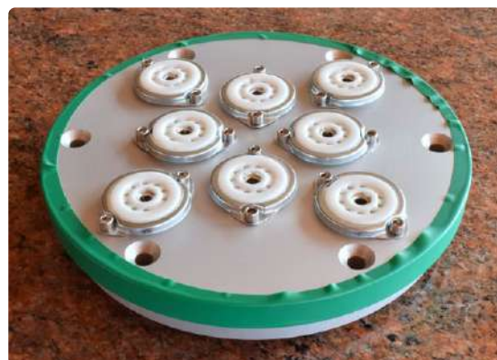
Figure 9. Construction mécanique attrayante pour les composants électroniques : les douilles de tous les tubes de l'amplificateur stéréo.
