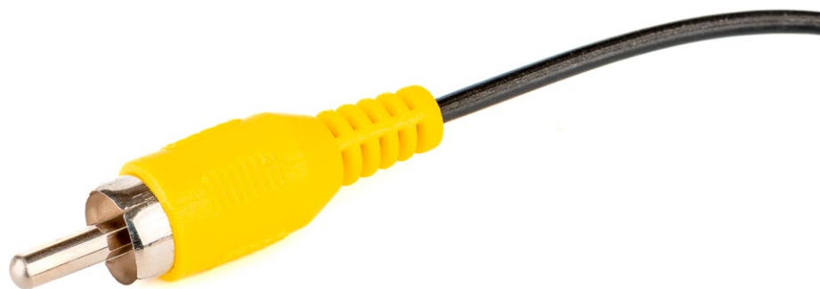
Figure 8. Câble pour vidéo composite avec fiche RCA. (Source : Shutterstock/Woodpond)
