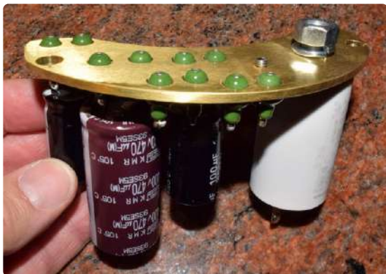
Figure 14. Les gros condensateurs électrolytiques ont leur propre plaque de laiton.
