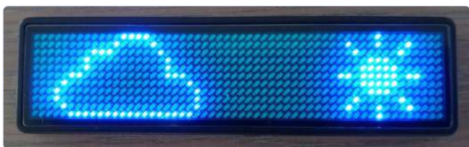
Figure 6. En envoyant les commandes BLE appropriées, vous pouvez afficher vos propres images de 11 x 55 pixels sur le badge LED.
