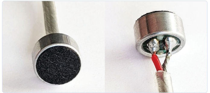
Figure 7. Petite capsule d'électret avec membrane de 5 mm.
