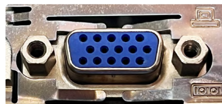
Figure 2. Prise VGA sur un PC (source : Dr. Thomas Scherer).
