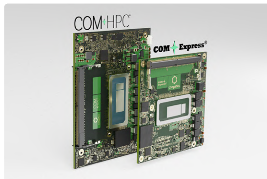
Figure 3. La toute dernière technologie processeur comme les processeurs haut de gamme Intel Core 13 e Gen en BGA se retrouve sur les modules COM-HPC et COM Express.
