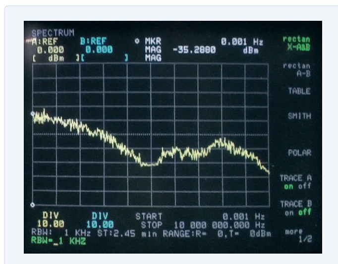
Figure 2. Les bandes étroites offrent une haute résolution mais imposent un temps de balayage plus long (Sweep Time)...
