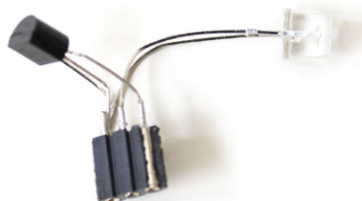
Figure 4. Mon module de commande/transmission infrarouge «maison».
