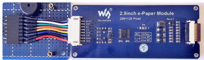
Figure 5. Le module e-papier utilisé dans le projet avec son connecteur « personnalisé ». (Source : Waveshare)
