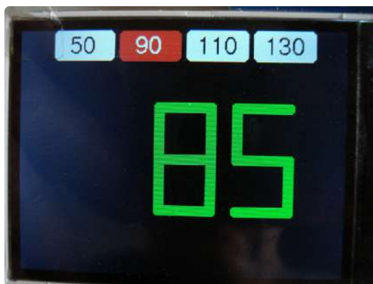
Figure 4. Sur l'écran 2, la vitesse réelle est affichée en chiffres de style 7 segments.
