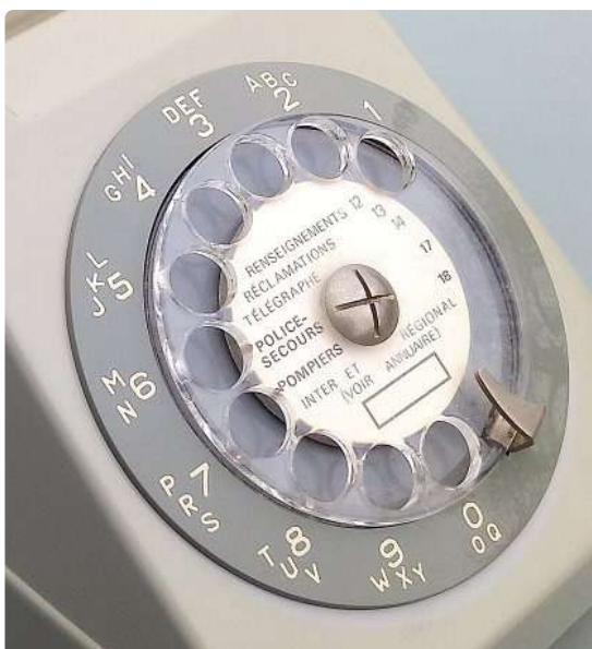
Figure 8. Il est facile d'envoyer des textos avec ce vieux téléphone grâce aux lettres imprimées autour du cadran. Par exemple, pour «elektor» on compose le 33-555-33-55-8-0-77, le tiret représentant une pause d'une seconde.
