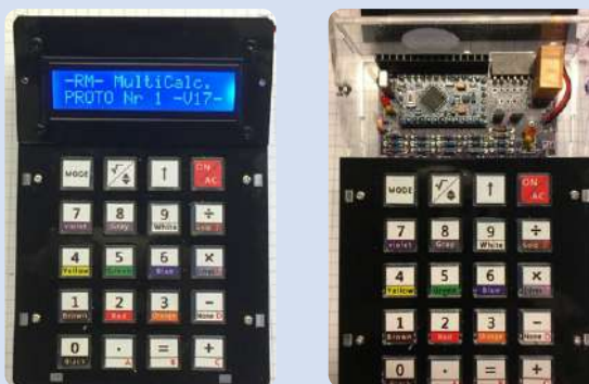
Figure 4. Vues externe et intérieure du multi calculateur.
