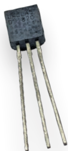
Figure 1. Le DS18B20 dans un boîtier TO-92.
