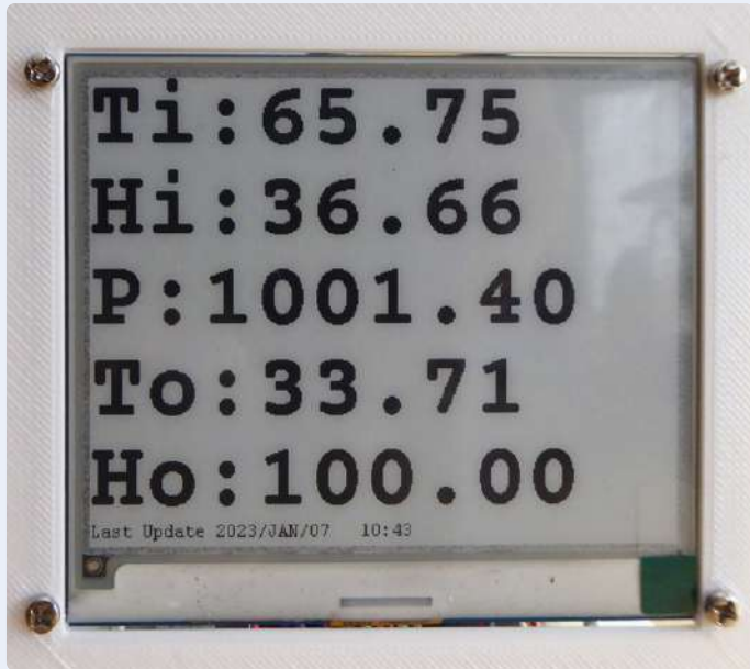
Figure 2. Mon écran ePaper affiche la température (en °F), l'humidité relative et la pression barométrique non corrigée/non normalisée. Les indices « i » et « o » désignent l'intérieur et l'extérieur. Seule la pression extérieure est affichée.
