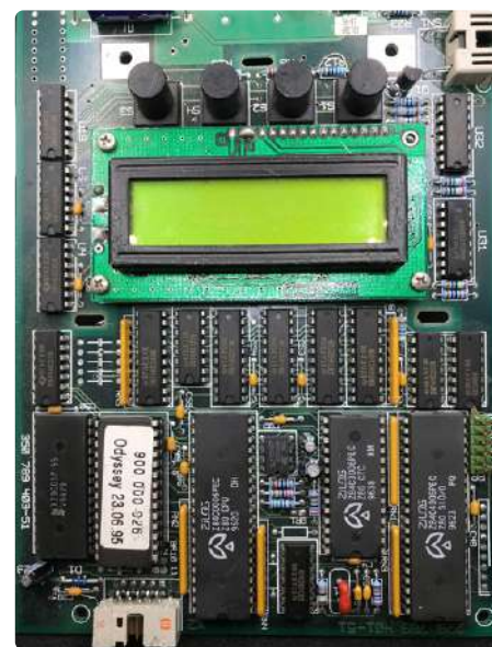
Figure 2. Le Z80 de Zilog était un autre cheval de bataille des premiers systèmes embarqués. Il est ici accompagné d'un contrôleur d'E/S série (SIO) et d'un circuit compteur/timer (CTC).
