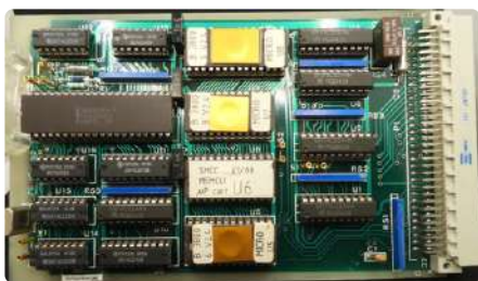
Figure 1. Datant du milieu des années 1980, cette carte est équipée d'un microprocesseur 8085. Combinée à six autres cartes (voir l'en-tête de l'article), elle est devenue aussi complète que les microcontrôleurs d'aujourd'hui !
