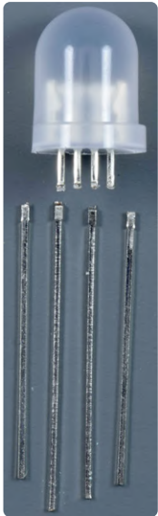
Figure 7. Les fils de la LED RVB WS2812D-F8 sont coupés juste au-dessus de l'élargissement.
