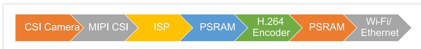
Figure 6. Exemple de flux de données pour une caméra IP.
