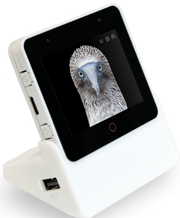
Figure 3. L'ESP32-S3-BOX-3 est équipée d'un écran de 2,4 pouces, de deux microphones et d'un haut-parleur.
