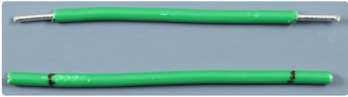
Figure 3. Un fil marqué et un autre dénudé. L'isolant restant doit avoir une longueur de 3 cm.
