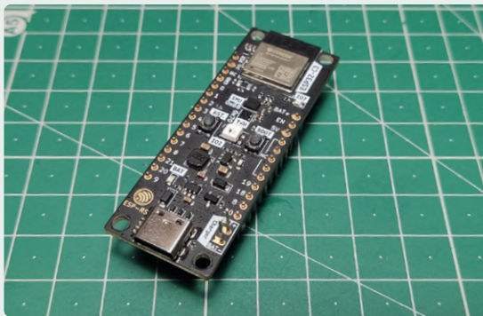
Figure 3. L'ESP32-C3 intègre un module de débogage USB avec une interface série, ce qui évite d'avoir recours à des sondes externes.
