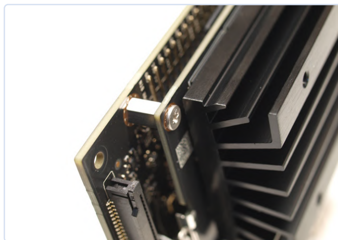
Figure 3. Le desserrage de deux vis permet de démonter le kit de développement.
