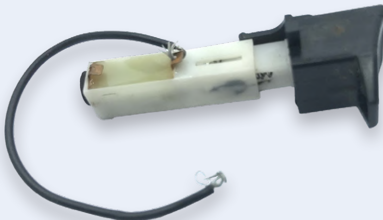
Figure 4. Allumeur piézoélectrique provenant d'un briquet à gaz. En appuyant sur le bouton situé à l'extrémité, il émet un « clic » et génère une impulsion haute tension qui produit une étincelle entre deux électrodes.
