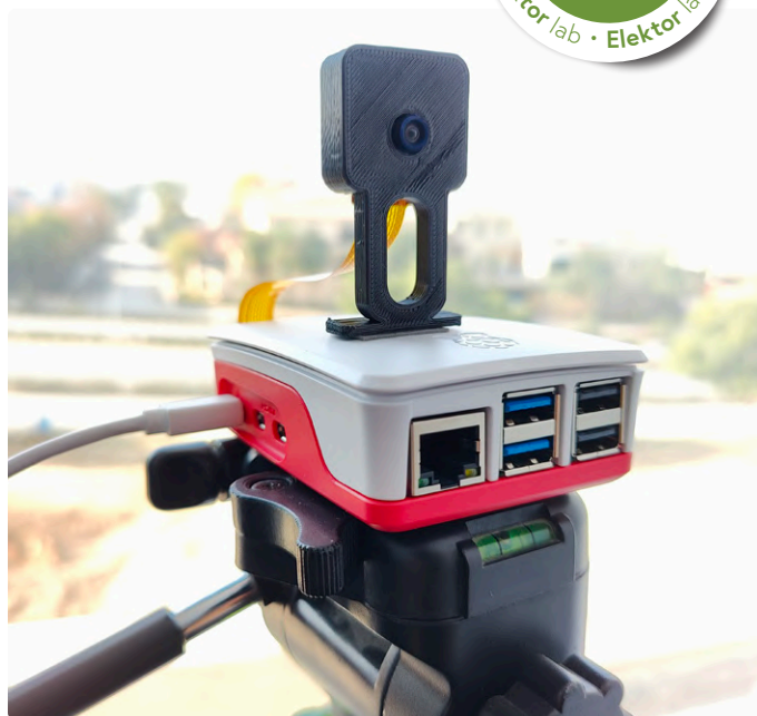
Figure 1. CaptureCount tournant sur un Raspberry Pi 5 avec le module Caméra du Raspberry Pi (Wide).
