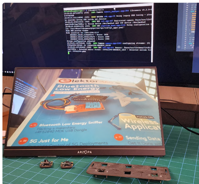
Figure 2. libcamera-hello nous indique que notre caméra fonctionne.
