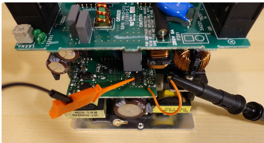
Figure 3. Comment faire une mesure sous tension en toute sécurité.
