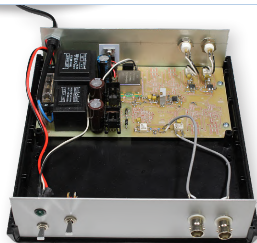
Figure 4. Circuit imprimé partiellement assemblé et installée dans un boîtier Teko.
