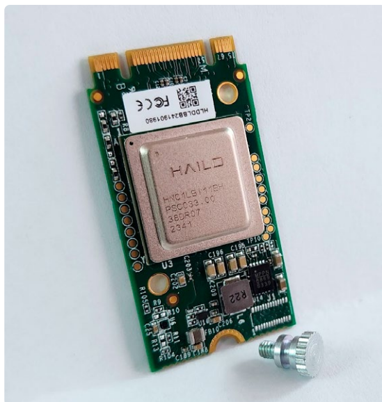
Figure 3. La carte accélératrice permet de connecter le module Hailo-8L au port PCIe via un connecteur M.2.
