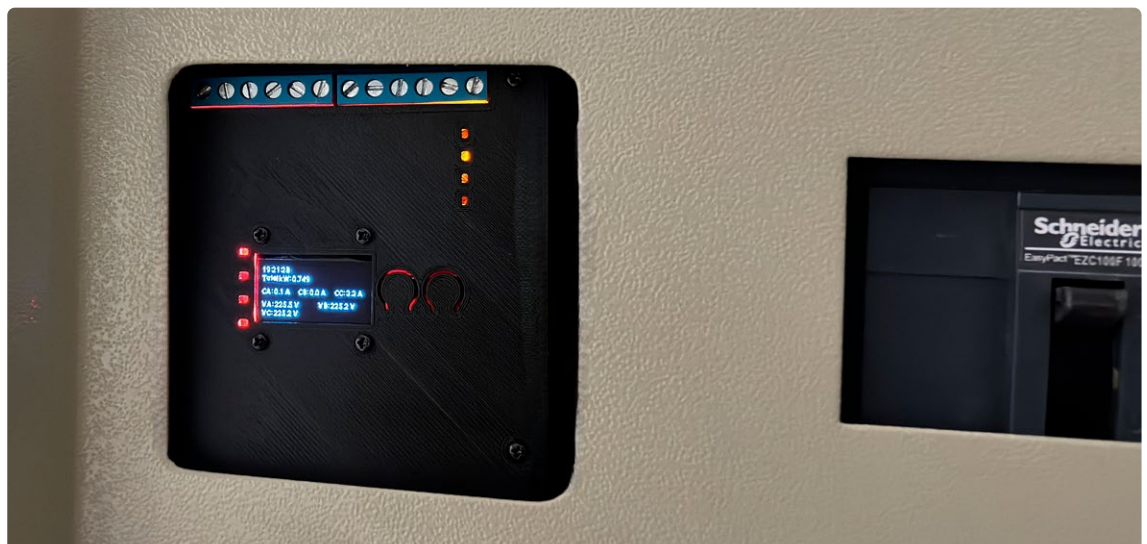
Figure 10. Compteur d'énergie ESP32 installé dans un tableau de disjoncteurs, surveillant la consommation d'énergie en temps réel.
