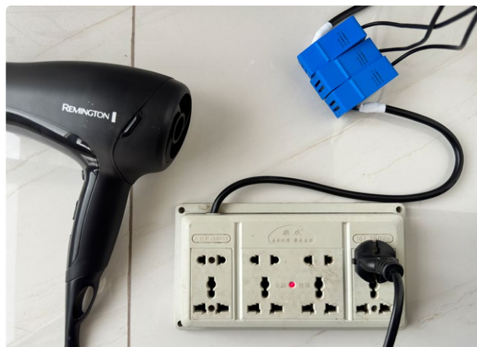
Figure 7. Configuration pour tester et calibrer le compteur d'énergie ESP32 en utilisant une charge variable.
