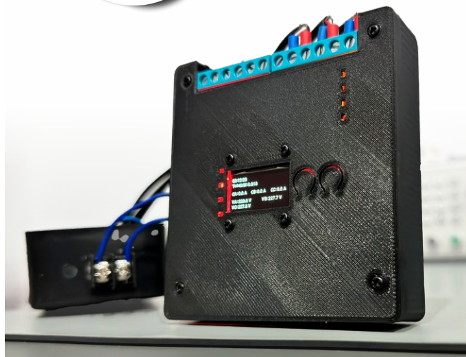
Figure 1. Le compteur d'énergie ESP32 assemblé avec son écran OLED et ses indicateurs d'état en direct.
