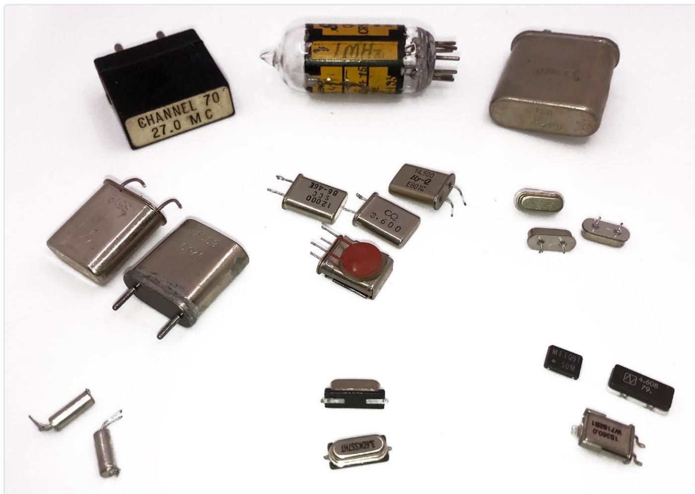
Figure 2. Différents quartz anciens et modernes. En haut : les plus anciens. Au milieu (de gauche à droite) : HC6/U, HC49/U (dont un avec un fusible rearmable PTC rouge utilisé comme « four ») et HC49S à trous traversants. En bas (de gauche à droite) : Cristaux de montre 32,768 Hz, HC49SMD, et autres quartz CMS.
