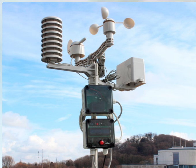
Figure 1. Projet de station météo d'Elektor [1].
