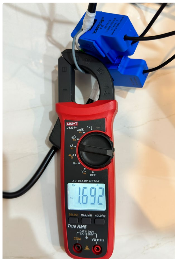
Figure 8. Pince ampèremétrique pour le calibrage.
