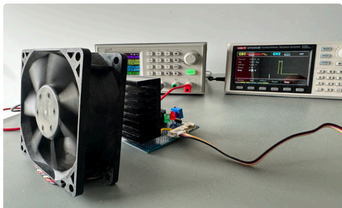
Figure 2. Configuration de test, le générateur de fonctions est utilisé pour contrôler le circuit avec un signal PWM.
