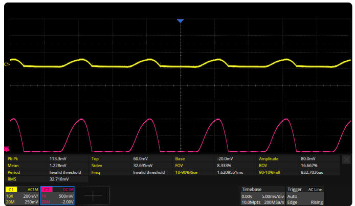
Figure 5. Oscillogramme en fin de charge. Ici, la trace violette montre des pointes à 10 A, tandis que l'ondulation sur la batterie est de 113 mV. Le R_i calculé est alors d'environ 11 mΩ, soit 20 % de moins qu'en début de charge.
