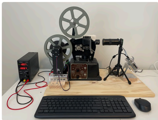
▲ Figure 3. Configuration d'un numériseur de film « maison ».
