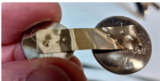
Figure 5. Souder un ruban de nickel à une pile bouton.
