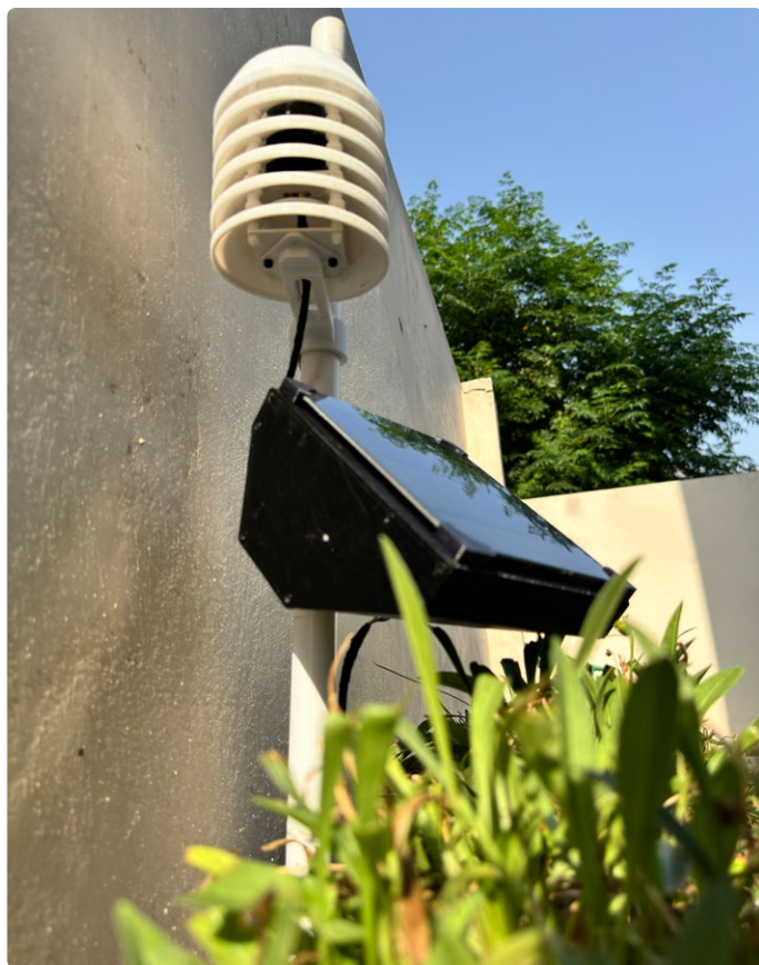
Figure 17. Vue en contre-plongée du nœud de capteur LoRa, présentant le boîtier Stevenson.
