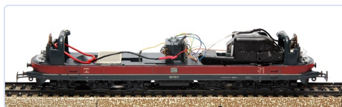
Figure 2. L'espace disponible dans la locomotive pour le module camera.
