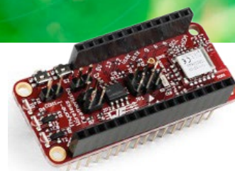
Figure 1. Carte de développement Wireless FeatherWing Thyone-I de Würth Elektronik dotée d'un module RF propriétaire de 2,4 GHz. (Source : Würth Elektronik eiSos)
