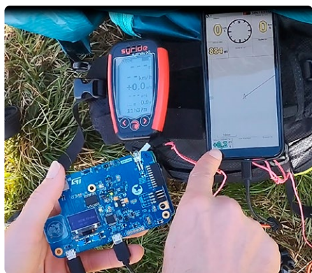
Figure 5. Variomètre commercial utilisé pour comparer les mesures faites par mon Open Vario.
