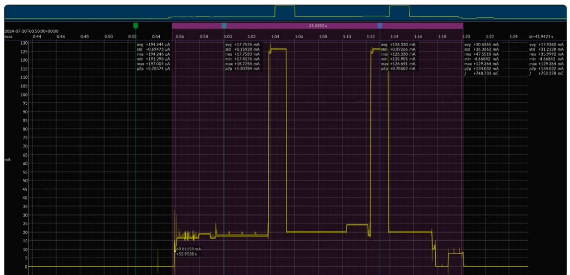
Figure 11. Consommation de courant du module LoRa E5 Module, avant (à gauche) et après (à droite) la mise en œuvre de la fonction sommeil.
