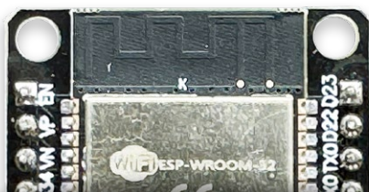
Figure 1. L'antenne quart d'onde en forme de F « imprimée » sur une carte ESP32.
