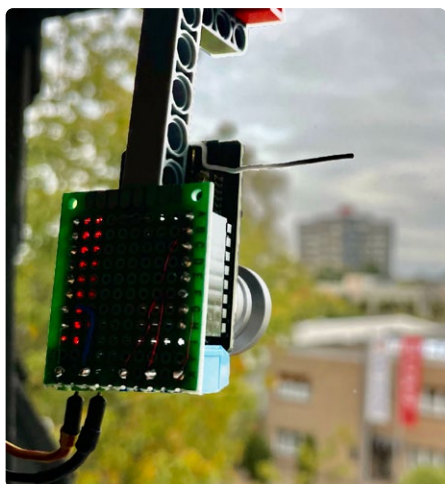
Figure 6. ESP32-CAM avec antenne modifiée.
