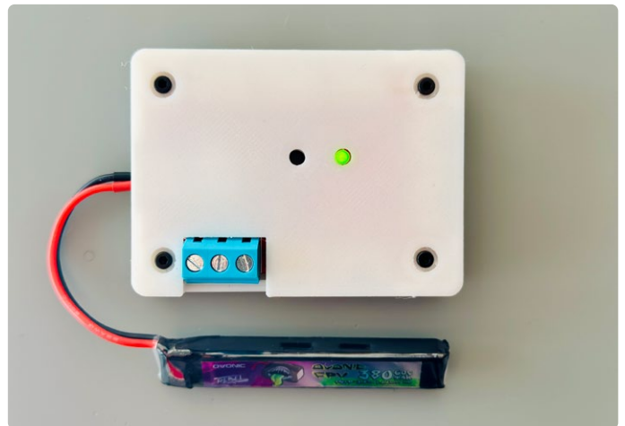
Figure 6. La carte eXpansion alimentée par une batterie LiPo.
