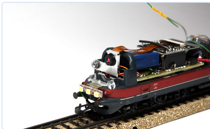
Figure 7. Trois LED blanches à l'avant de la locomotive.
