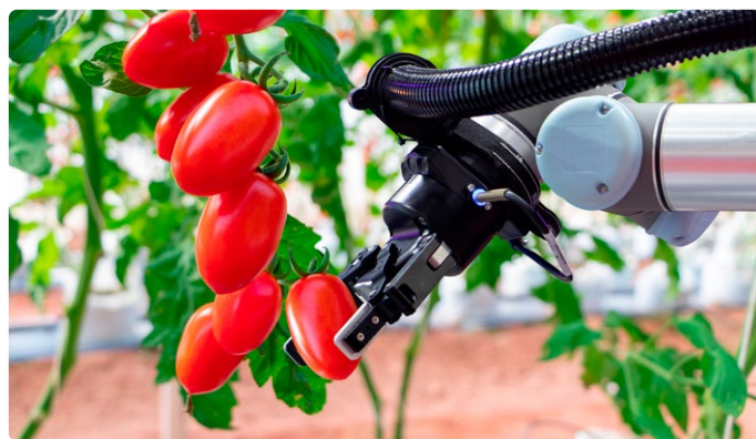
Figure 2. Les robots utilisés pour la cueillette des tomates s'appuient généralement sur une technologie de vision industrielle basée sur l'apprentissage automatique (ML) afin de déterminer si les tomates sont mûres (Source : kritsana – stock.adobe.com)
