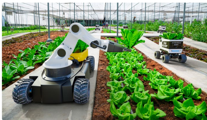
Figure 1. Un robot cueilleur automatisé avec chariot collecteur (Source : kinwun – stock.adobe.com)
