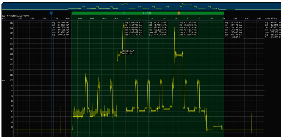
Figure 12. Forme d'onde de courant du système entier, après les optimisations de puissance.
