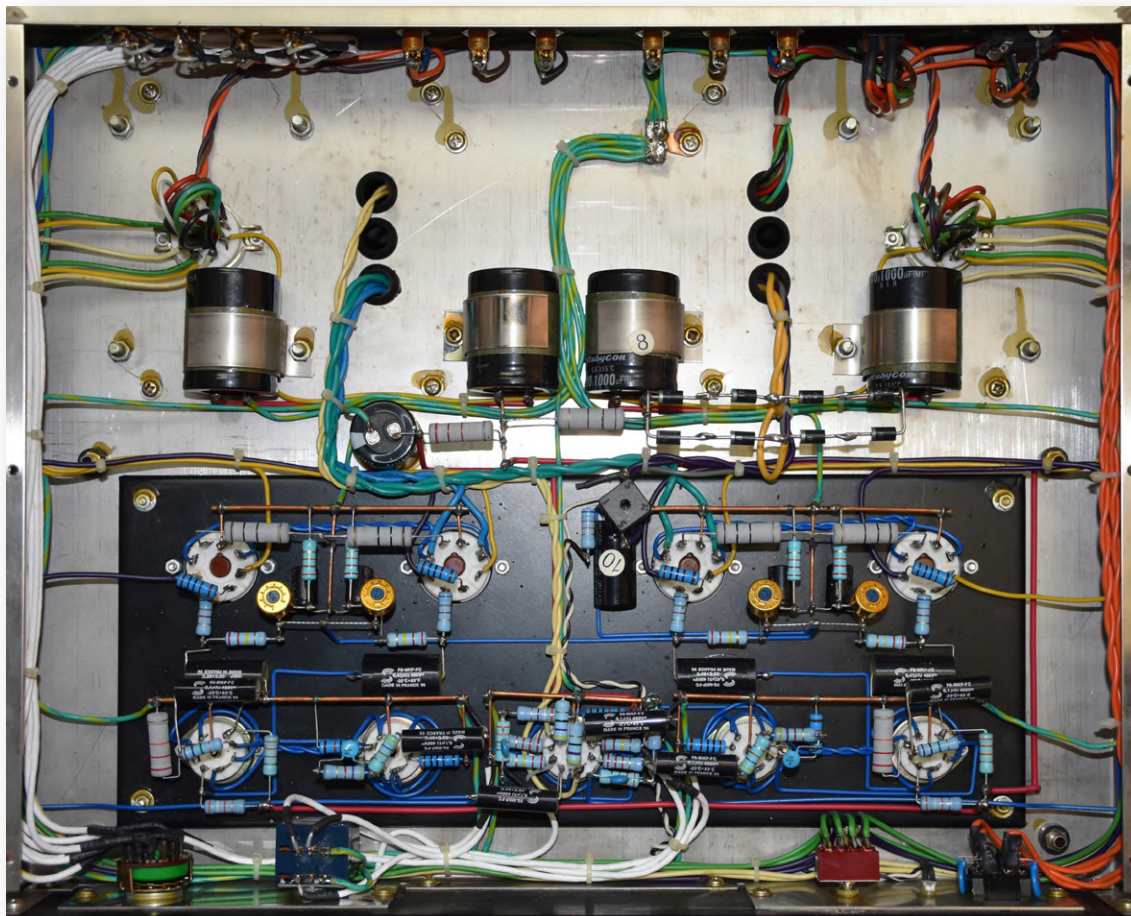
Figure 1. Vue de dessous du câblage volant d'un amplificateur utilisant des tubes KT-88, appartenant à l'auteur. La disposition des composants est claire, et la dissipation thermique correcte. La zone où un isolement électrique renforcé est nécessaire se reconnaît par la présence d'une feuille d'époxy noir. Le montage des composants volumineux, tels que les condensateurs électrolytiques, nécessite des fixations individuelles (supports métalliques). À certains emplacements, les composants sont disposés en couches superposées, ce qui peut compliquer les opérations de maintenance.
