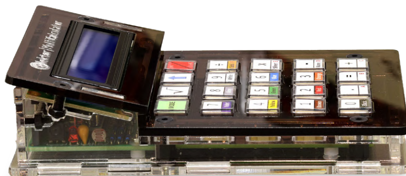
Figure 6. La carte entièrement peuplée sans l'afficheur LCD.
