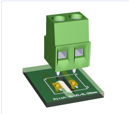
Figure 4. L'alésage entre les plots et les traces augmente fortement l'isolement d'un circuit imprimé, sur lequel ces découpes sont également utilisées pour séparer les zones ayant une différence de potentiels élevée.
